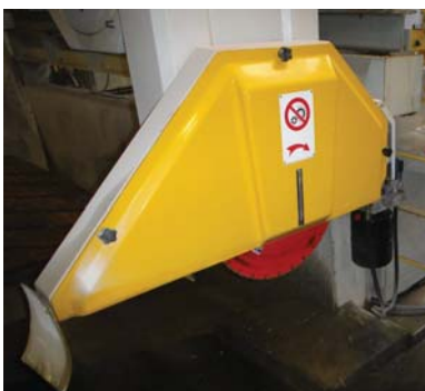
Bild 6: SE des Sägeblattes mit Befestigungsmittel
