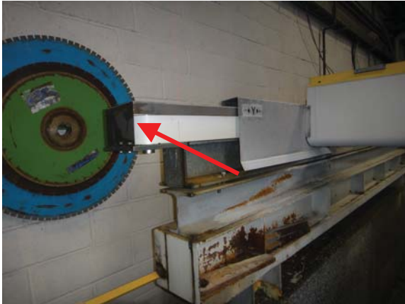
Bild 4: Einzugs- bzw. Quetschstellen an den Laufschielen links und rechts der Maschine
