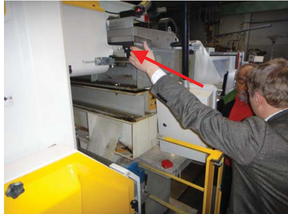
Bild 4: Einzugs- bzw. Quetschstellen an den Laufschielen links und rechts der Maschine
